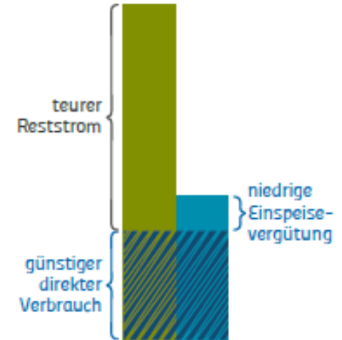
kleine PV-Anlage im Verhältnis zu großem Mieterstrombedarf
