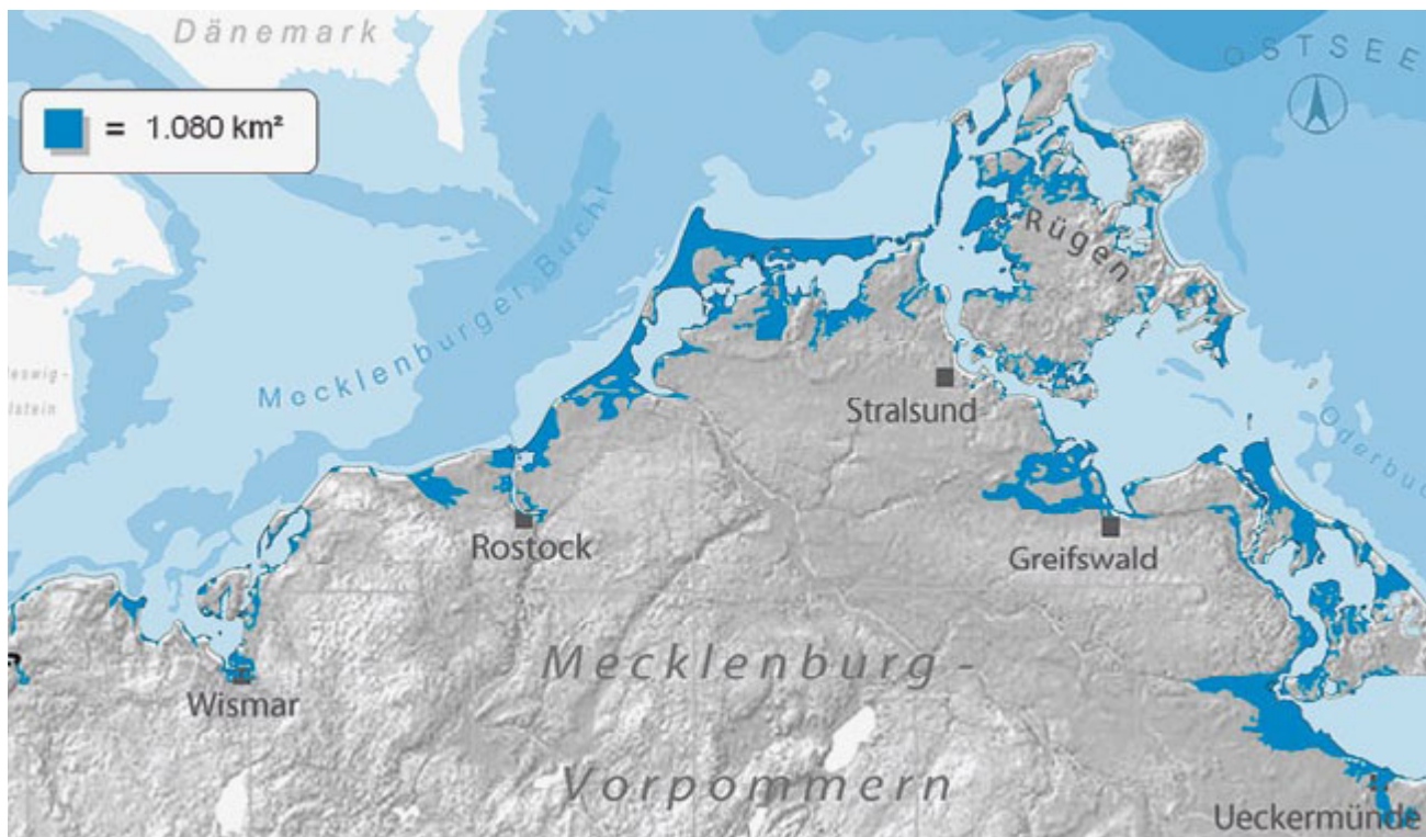
1.4 > Potentielle Überflutungsfläche im Falle einer Bemessungssturmflut in MV bei nicht vorhandenen Schutzanlagen
