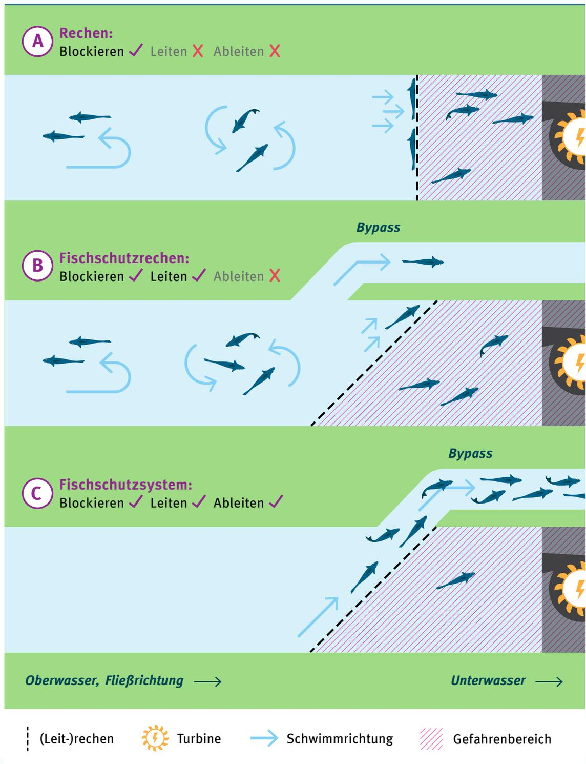
Ein Fischschutzsystem besteht immer aus einem Fischschutzrechen und einem Bypass, die funktional aufeinander abgestimmt sind.
