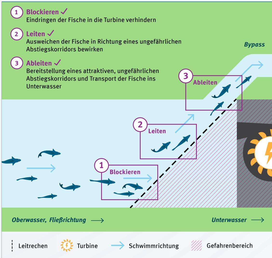
Schematische Darstellung (Draufsicht) der drei Funktionen eines Fischschutzsystems: Blockieren, Leiten, Ableiten
