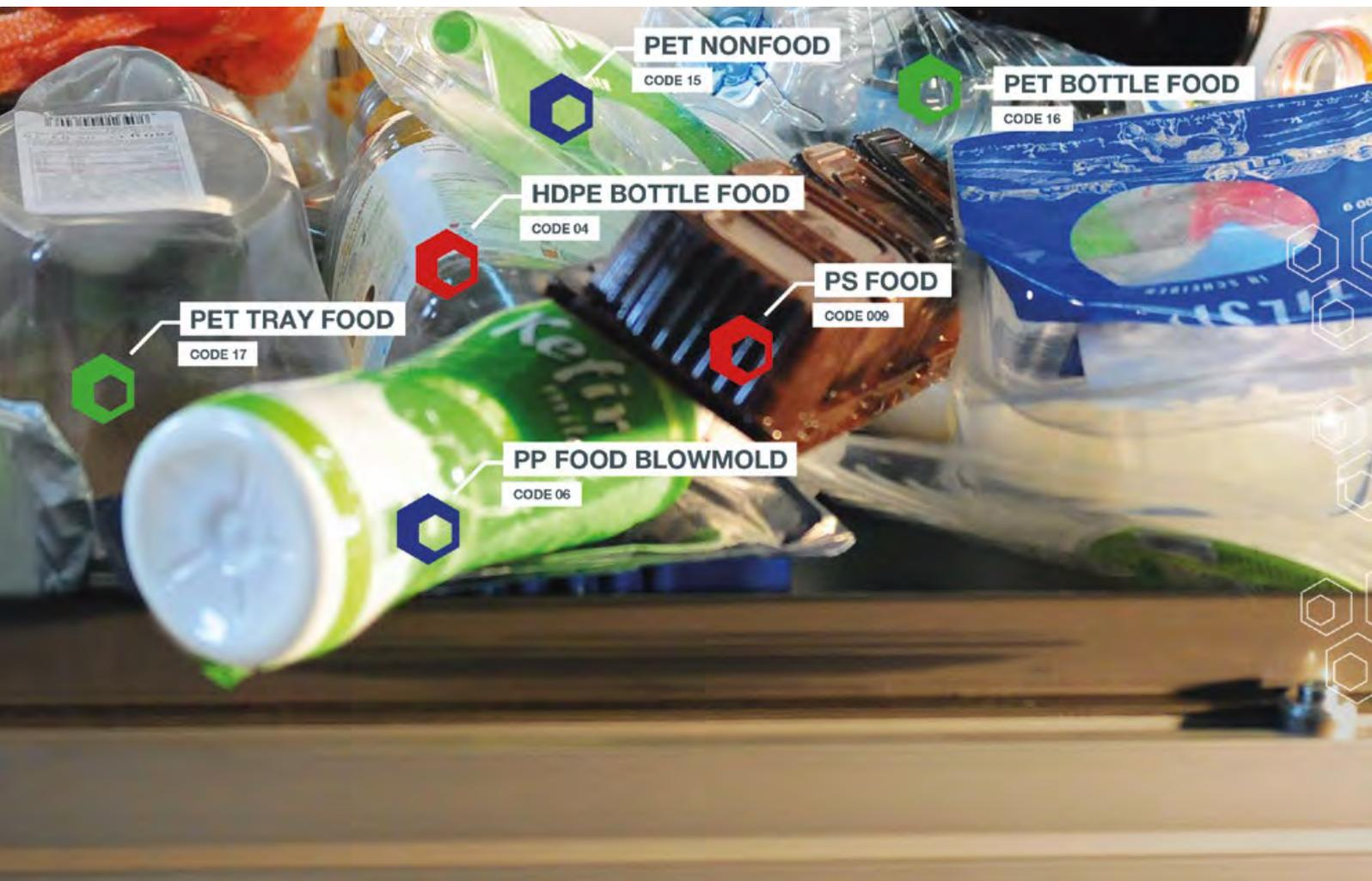
Die Tracer-Based-Sorting-Technologie kann es ermöglichen, Verpackungsmüll in zahlreiche unterschiedliche Kategorien zu sortieren und dadurch höhere Recyclingquoten zu erreichen.
