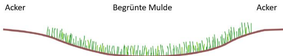
Abbildung 24: Prinzipskizze einer begrünten Abflussmulde © Eigene Darstellung, basierend auf boden-staendig.eu
