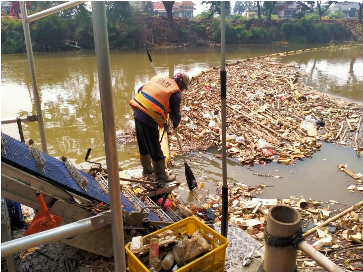
Abbildung 5: Einsatz eines SeeHamsters mit Förderband in Jakarta. Quelle: Foto von © One Earth – One Ocean (OEOO), bereitgestellt von OEOO.
